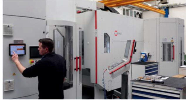
Seit Anfang 2021 läuft das MES und steuert digital die Fertigung von der Zeichnungsausgabe bis zur fertig kommissionierten Baugruppe. Bild: AWM
